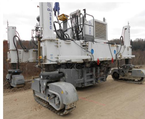
Система AccuSteer обеспечивает непараллельное движение и высокую точность при движении с поворотом тележек на 90° при любом положении консольных опор. Системы SmartLeg и AccuSteer, работая вместе, быстро меняют угол поворота консольных опор для обхода препятствий и фиксируют тележки в прямолинейном положении. Эти две системы быстро и в полуавтоматическом режиме переводят машину в транспортное положение.
