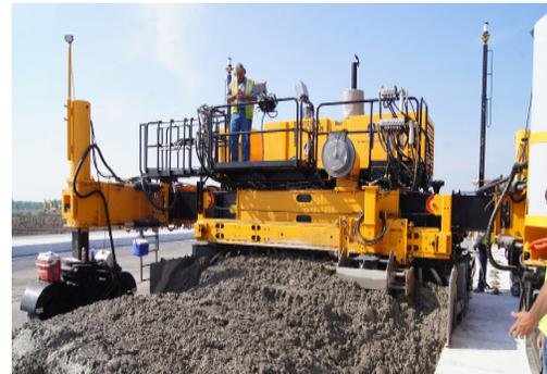
Рабочую ширину плужного распределителя G&Z менять быстрее чем у шнекового. Составные направляющие тележки распределителя не требуют промежуточных креплений.
