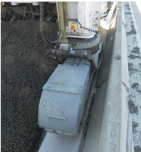
S850SL – самый малогабаритный укладчик на рынке. При ширине гусеницы 228мм между барьером и кромкой плиты всего 305мм.
